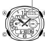
Un LED (diode a emissione luminosa) illumina il quadrante dell'orologio per una facile visione delle indicazioni al buio. La funzione di illuminazione automatica dell'orologio fa accendere automaticamente l'illuminazione quando si orienta l'orologio verso il proprio viso.
