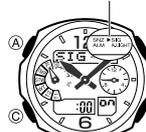
1. Nel modo di suoneria, usare **D** per selezionare il segnale orario di ora esatta (**SI G**).
