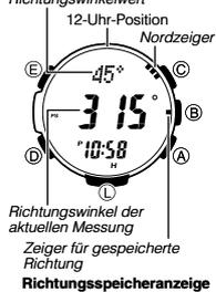
Der Richtungsspeicher ermöglicht vorübergehendes Speichern und Anzeigen einer Richtungsmessung, um diese dann mit nachfolgenden Digitalkompass-Messungen vergleichen zu können. Die Anzeige des Richtungsspeichers zeigt den Richtungswinkel der gespeicherten Richtung sowie einen Zeiger an, der ebenfalls die gespeicherte Richtung zeigt.
