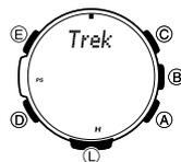
Halten Sie im Höhenmessermodus mindestens fünf Sekunden lang (A) gedrückt. Zunächst blinkt **Trek Hold** im Display. Danach verschwindet **Hold** und ein Zeiger (■), der die abgelaufene Messzeit anzeigt, erscheint bei 12 Uhr. Geben Sie (A) frei, wenn **Hold** verschwunden ist.
