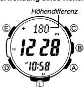
Die Anzeige des Höhenmessermodus enthält auch einen Höhendifferenzwert, der die Höhenänderung gegenüber einem von Ihnen festgelegten Bezugspunkt anzeigt. Der Höhendifferenzwert wird mit jeder Höhenmessung durch die Uhr aktualisiert.
