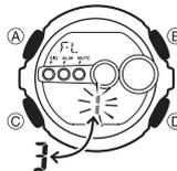
1. En mode Indication de l'heure, appuyez sur (A) jusqu'à ce que les secondes se mettent à clignoter, ce qui indique l'écran de réglage.
