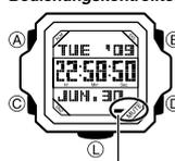
Halten Sie in einem beliebigen Modus (außer bei angezeigter Einstellanzeige) den Knopf **(C)** gedrückt, um den Kontrollton ein- (Stummschalt-Indikator nicht angezeigt) und auszuschalten (Stummschalt-Indikator angezeigt).
